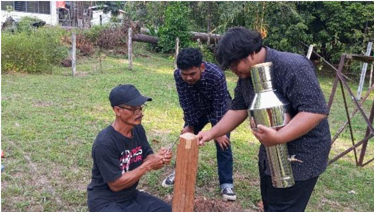
Gambar 8. Pemasangan ombrometer (alat penakar curah hujan) oleh mahasiswa PKL di Stasiun Riset Km 54 KHDTK HPPUM Universitas Mulawarman.
